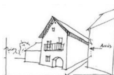
La façade pignon est ouverte sur le sud, le volume est massif, peu ouvert et le mur est enduit en totalité.
