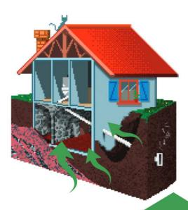
Le gaz radon peut s'infiltrer dans un bâtiment à travers chaque défaut d'étanchéité (percement, trou, fissure, vide autour des canalisations et gaines techniques, etc...) situé entre le sol et le bâtiment. Il risque ensuite de s'y accumuler si le renouvellement d'air dans le bâtiment est insuffisant, par exemple lorsque le système de ventilation est défectueux.
