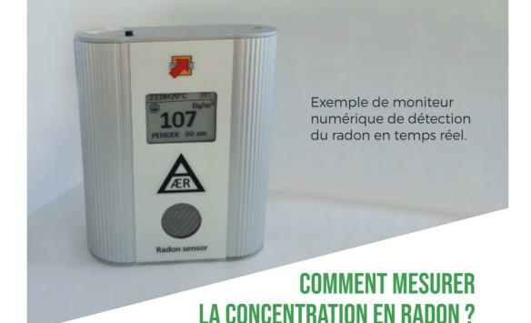
Pour une mesure fine de la concentration en radon, des dosimètres sont placés dans les pièces de vie pendant 2 mois minimum et pendant la période de chauffe du bâtiment (automne, hiver).
